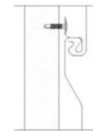
Узел Б Стыковка панелей А250/СД
