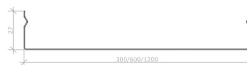
Потолочные панели системы AC крепятся на направляющие (несущий профиль ВТ-600) путём защёлкивания.
